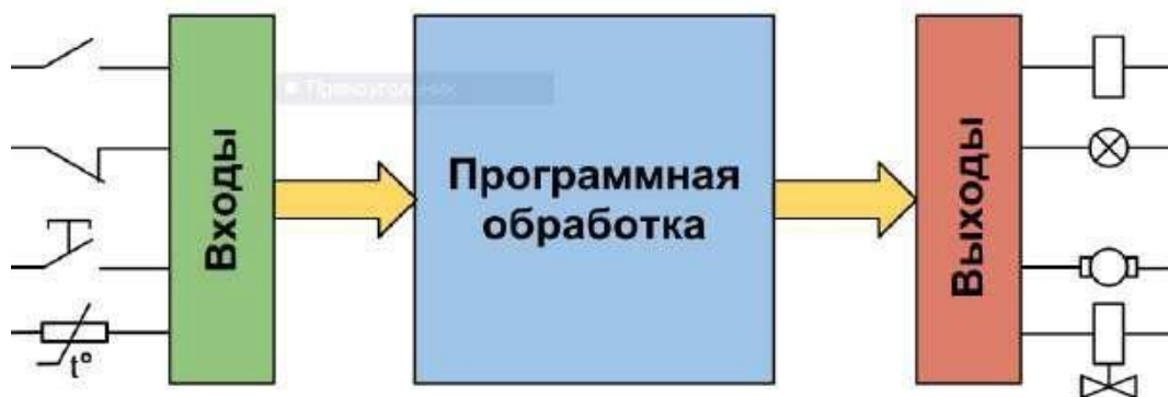
Рисунок 1 – Структурная схема ПЛК.
