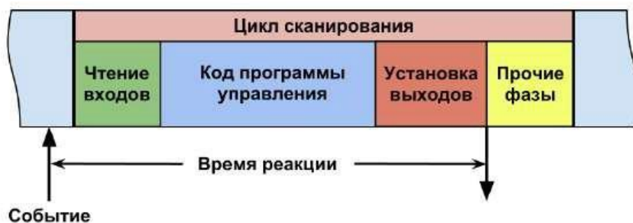
Рисунок 2 – Рабочий цикл ПЛК.
