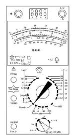
ВЗ. Вопрос: Отсчет по шкале прибора с пределами измерений  $\pm 50$  единиц и равномерной шкалой составил 25 единиц. Пренебрегая другими видами погрешностей измерения, оценить пределы допускаемой абсолютной погрешности этого отсчета при использовании СИ класса точности 0.5.
