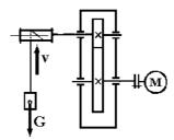
5. Прочитать кинематическую схему, определить ее элементы. Вес груза G=1000~H; Скорость подъема груза v=8 м/сек; КПД барабана лебедки  $\eta_6=0.8$ ; КПД цилиндрической передачи  $\eta_{\rm H}=0.98$ ; Элементы конструкции приведены на схеме.
