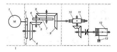
2. Прочитать кинематическую схему, определить ее элементы. Мощность на ведущем валу  $P_1=8~$  кВт; Угловая скорость ведущего вала  $\omega_1=40~$  рад/сек; Коэффициент полезного действия передачи  $\eta=0.97;$  Передаточное число передачи u=4.
