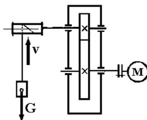
5. Прочитать кинематическую схему, определить ее элементы. Вес груза  $G = 1000$  Н; Скорость подъема груза  $v = 8$  м/сек; КПД барабана лебедки  $\eta_b = 0,8$ ; КПД цилиндрической передачи  $\eta_{ц} = 0,98$ ; Элементы конструкции приведены на схеме.
