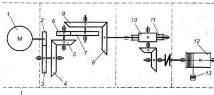
2. Прочитать кинематическую схему, определить ее элементы. Мощность на ведущем валу  $P_1 = 8 \text{ кВт}$ ; Угловая скорость ведущего вала  $\omega_1 = 40 \text{ рад/сек}$ ; Коэффициент полезного действия передачи  $\eta = 0,97$ ; Передаточное число передачи  $u = 4$ .
