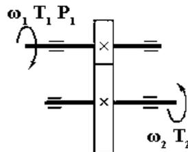
3. Прочитать кинематическую схему, определить ее элементы. Мощность на ведущем валу  $P_1 = 13 \text{ кВт}$ ; Угловая скорость ведущего вала  $\omega_1 = 57 \text{ рад/сек}$ ; Коэффициент полезного действия передачи  $\eta = 0,97$ ; Передаточное число передачи  $u = 8$ .
