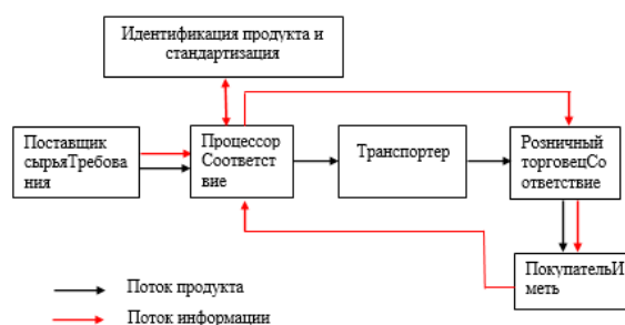
Рисунок 7. Продукт и информационный поток в системе прослеживаемости рыбных котлет
