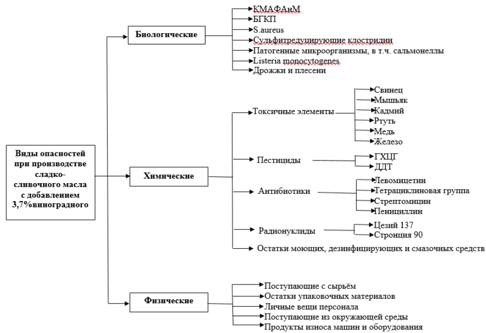
Рисунок 35. Дерево идентифицированных опасных факторов при производстве масла сливочного с антиоксидантами
