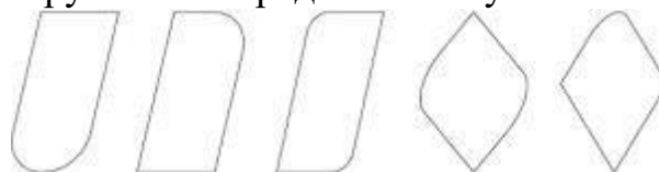
Рис. 2. Примеры геометрических фигур, полученных из прямоугольника настройкой параметров скругления определенного угла
