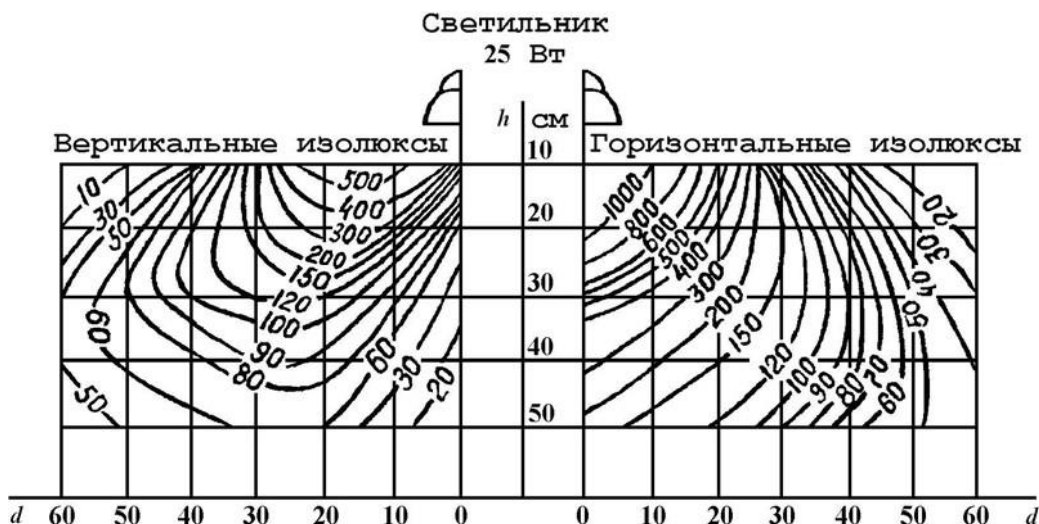
Рис. 3.3. Кривые одинаковых освещенностей светильника с лампой накаливания 25 Вт
