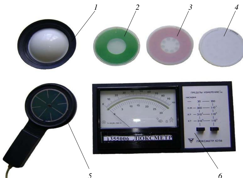
Рис. 2.3. Общий вид люксметра Ю-116: 1 – полусферическая насадка К; 2, 3, 4 – насадки с коэффициентами ослабления: М = 10, Р = 100, Т = 1000 соответственно; 5 – фотоэлемент; 6 – милливольтметр
