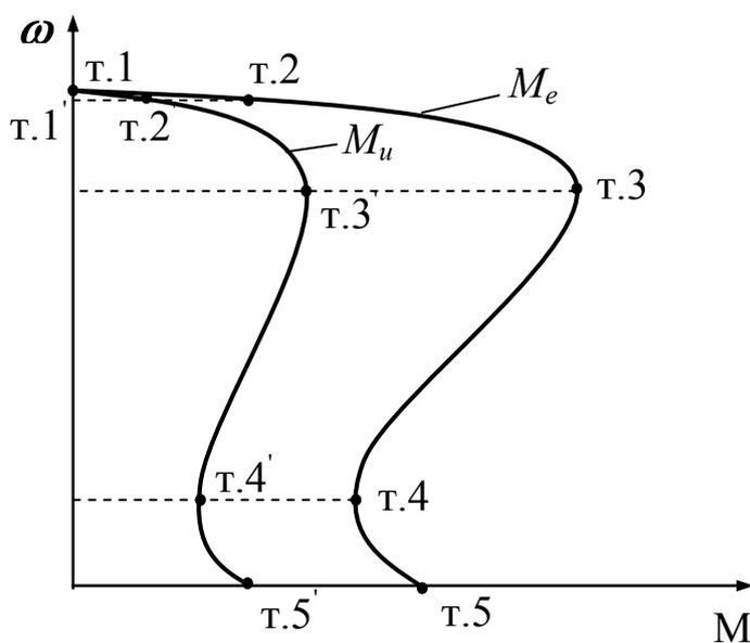
Рисунок 3 – Естественная и искусственная механические характеристики
