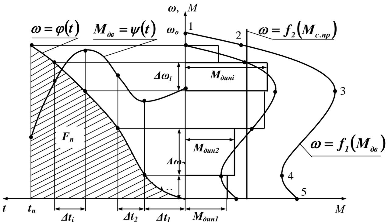
Рисунок 4 – К расчету продолжительности пуска двигателя
