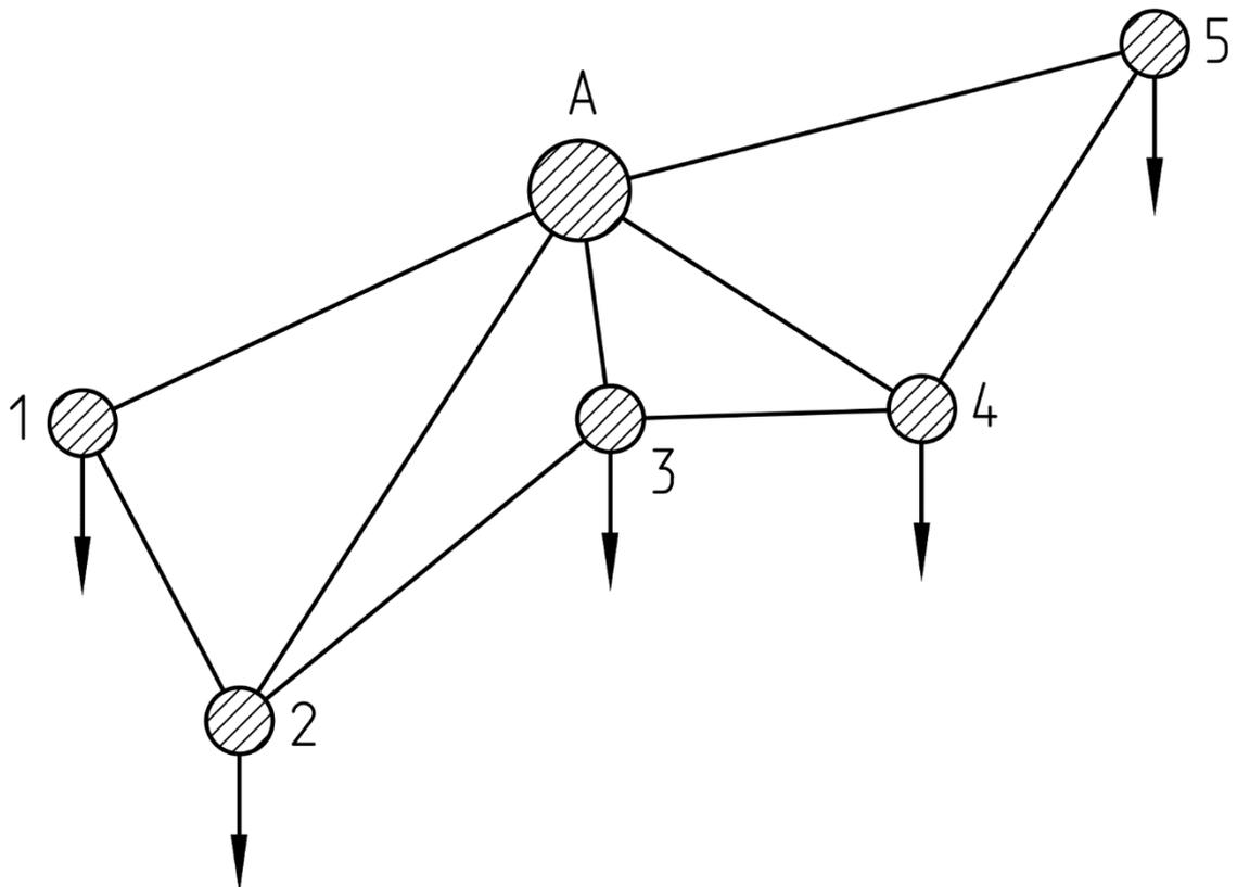
Рисунок 1– Схема районной электрической сети с расчётными нагрузками.
