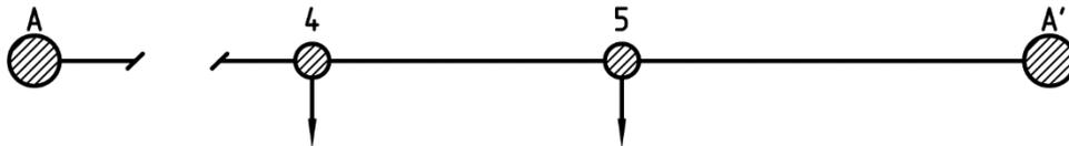
Рисунок 8 – Послеаварийный режим для участка А-4-5-А': отключение ВЛ А - 4.
