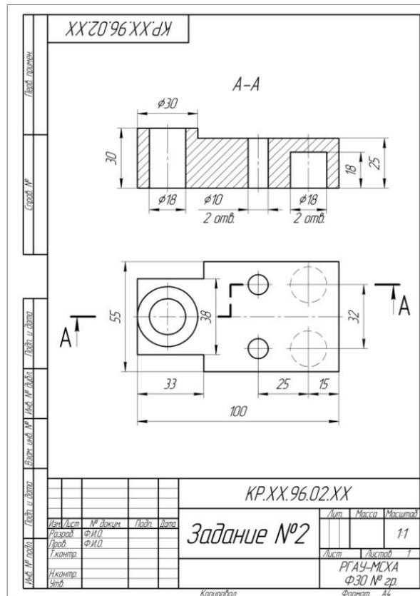
Рис. 2. Задание №2 – Выполнить сложный разрез при помощи системы AutoCAD на формате листа А4, расставив все размеры и обозначения согласно ГОСТ 2.307-2011.
