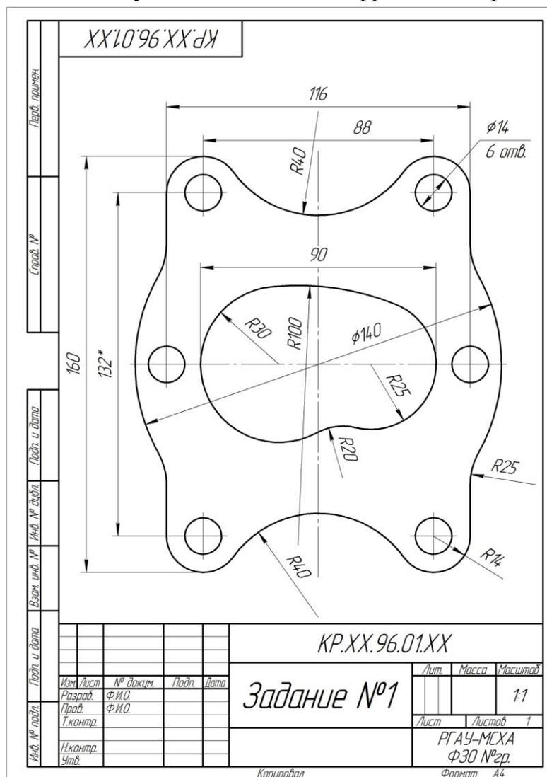
Рис. 1. Задание №1 – Выполнить геометрические построения при помощи системы AutoCAD, расставив все размеры согласно ГОСТ 2.307-2011.
