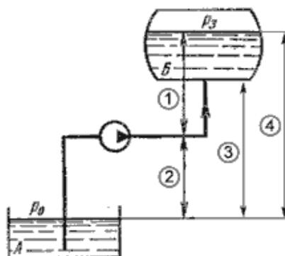
8. Укажите на рисунке геометрическую высоту нагнетания
