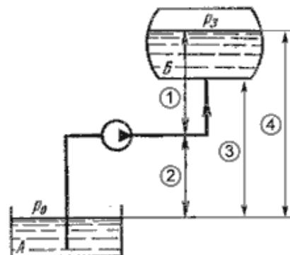
8. Укажите на рисунке геометрическую высоту нагнетания
