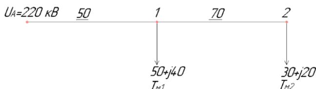
Провод АС-300;  $T_{\text{м1}} = 4000 \text{ ч};$
