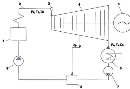
Тепловая схема ПТУ с одним подогревателем питательной воды смешивающего типа
