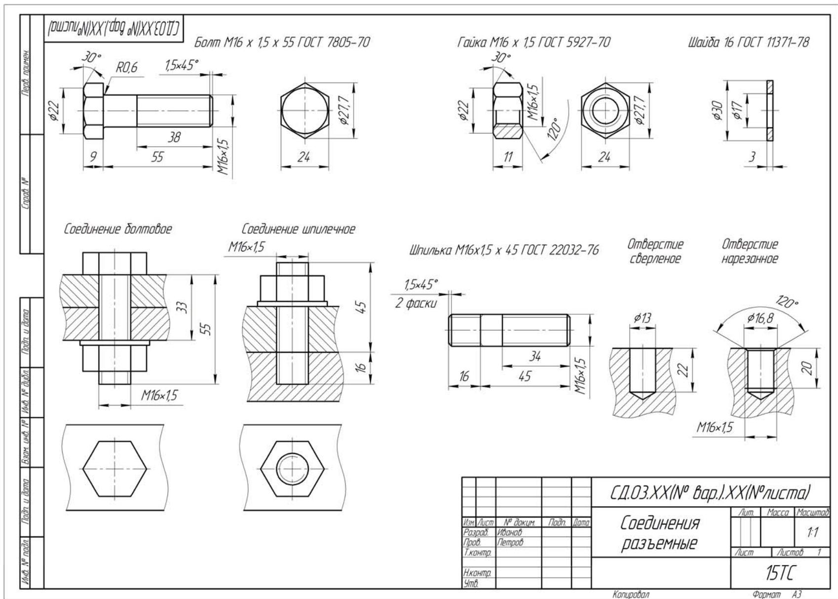
Рис. 8. Графическая работа «Соединения деталей» (Лист 10 – Соединения резьбовые)
