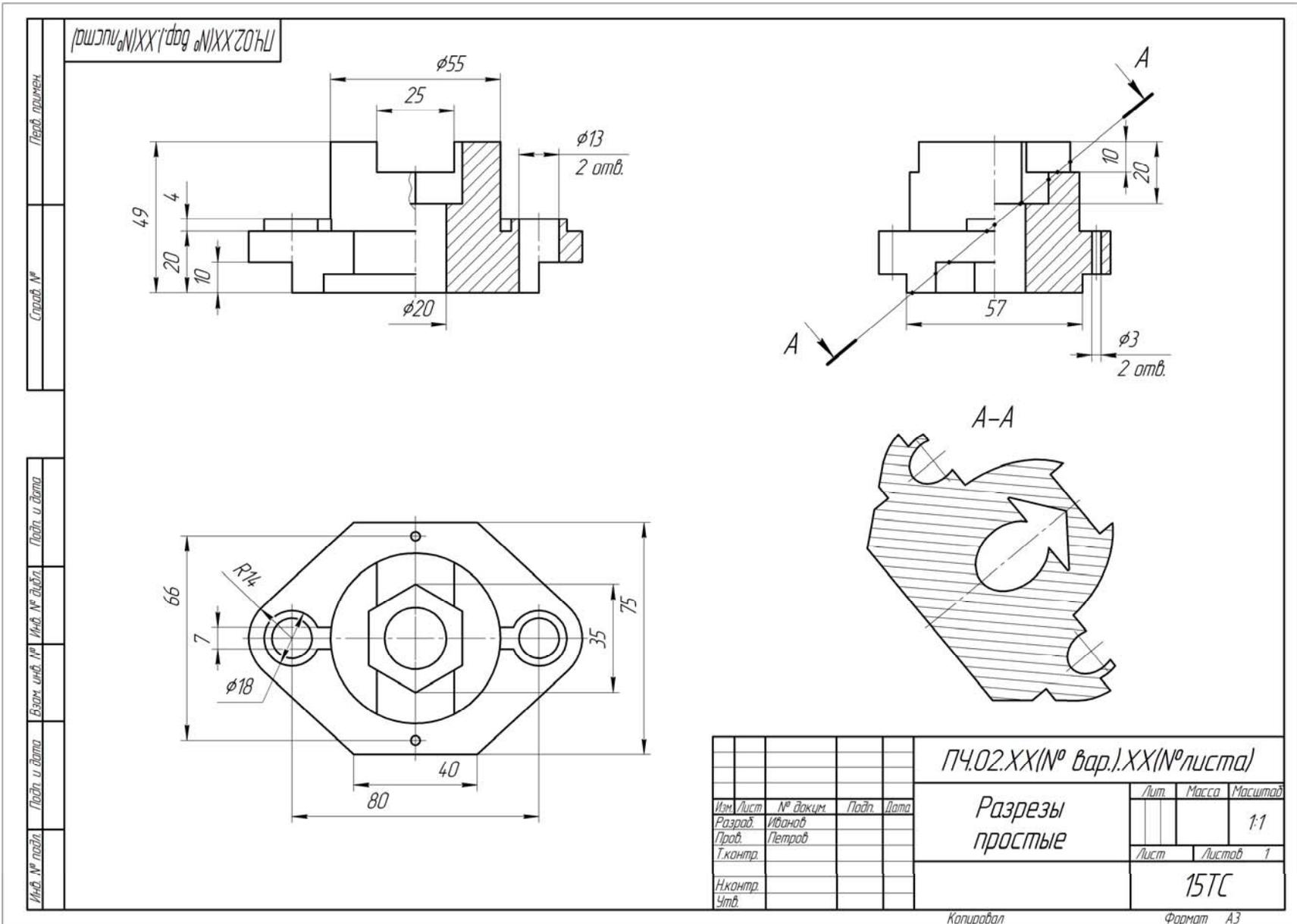
Рис. 5. Графическая работа «Проекционное черчение» (Лист 6 – Простые разрезы)
