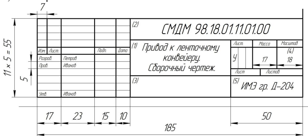
Рис. 4. Основная надпись по ГОСТ 2.10468 для первых листов чертежей и схем
