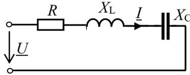
5. В схеме последовательного колебательного контура  $u = 100 \sin 314t$ ,  $I = 2 \sin 314t$ ,  $R = X_L = 100$  Ом. Определить емкость конденсатора.
