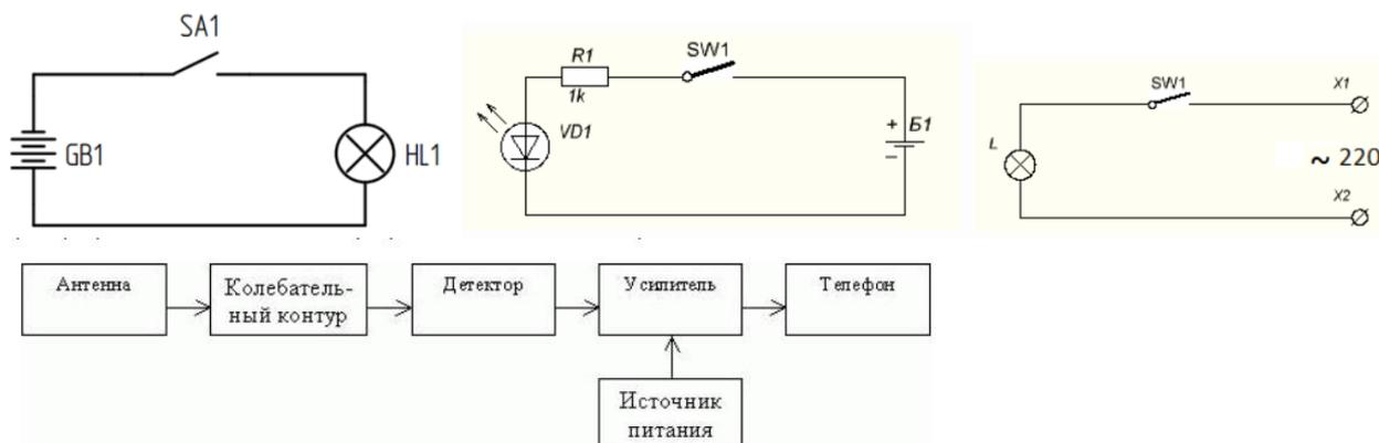
Рисунок 3.1 - Структурная схема приемника прямого усиления
