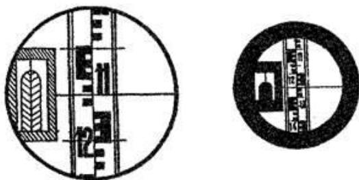
Рис.5. Поле зрения трубы нивелира. Снятие отсчета по рейке.
