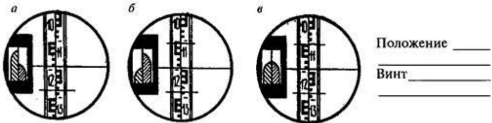
Рис. 4. Изображение пузырька цилиндрического уровня в поле зрения трубы нивелира Н-3.
