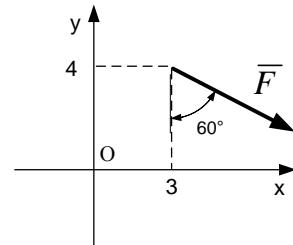
Приведенные на схеме нагрузки имеют следующие величины: сила  $F=10\text{kH}$ , момент пары сил  $M=20\text{kNm}$ , интенсивность распределенной силы  $q=5\text{kH/m}$ , весом тела следует пренебречь. Определить реакции опор.
